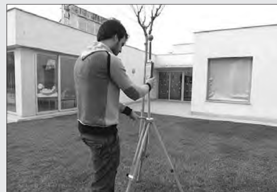
Mesuraments de camp electromagnètic
